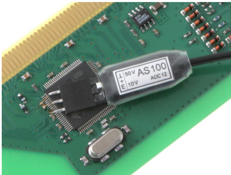
Bild 9 AS 100 an den Prüfling angeschlossen; wenn nicht genügend freie Oberfläche über GND vorhanden ist, dann auf IC-Gehäuse anordnen
